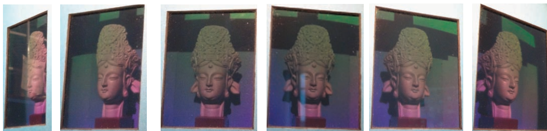
图3 静态三维全息图(由左向右拍摄的不同角度的照片)
