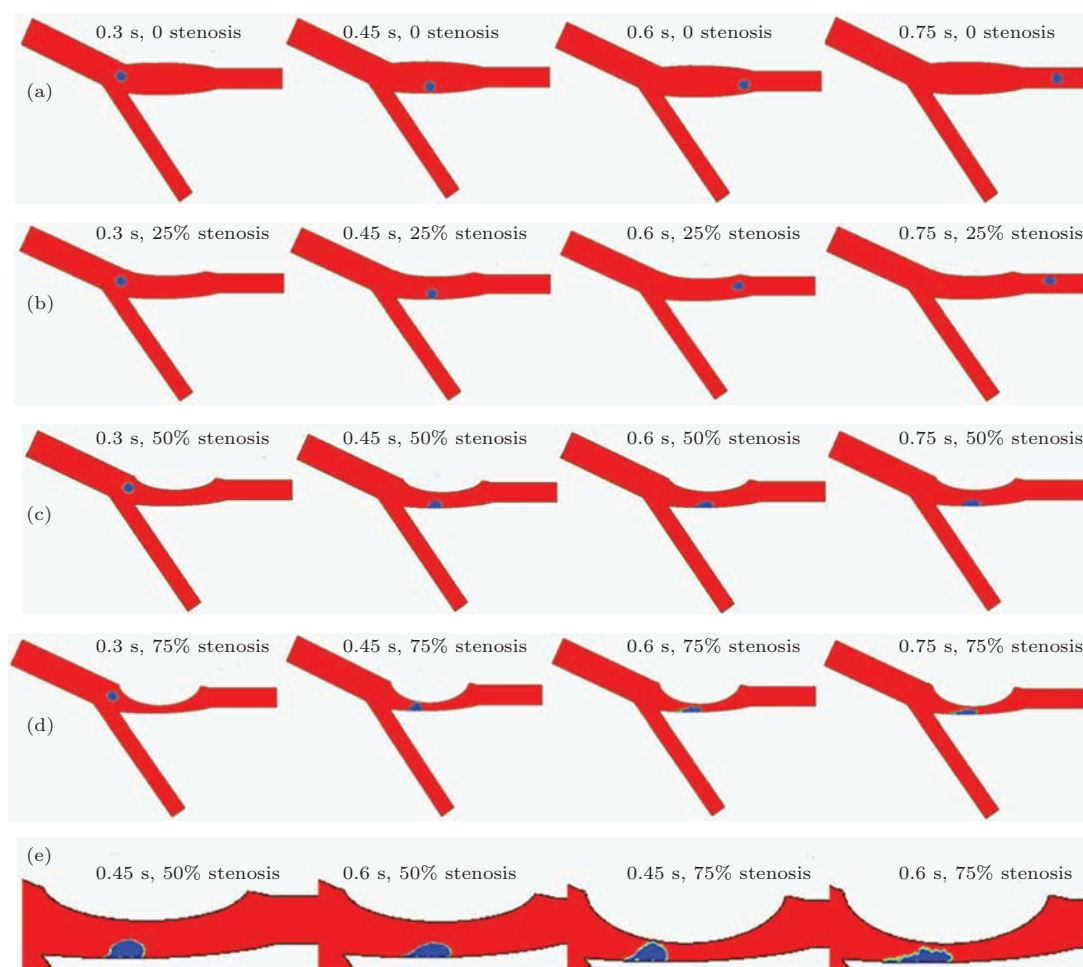
图7 (网刊彩色) (a)–(d) 对于不同狭窄度的血管, 脂肪颗粒在不同时刻的位置; (e) 局部放大图
