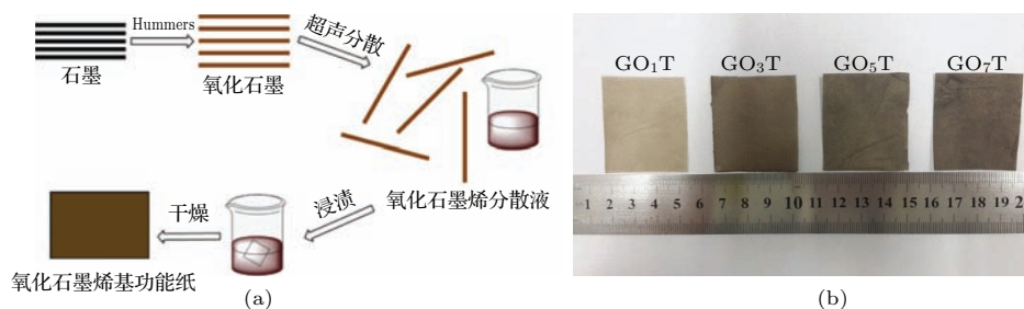
图2 (网刊彩色) 功能纸 (a) 制备流程示意图; (b) 实物图
