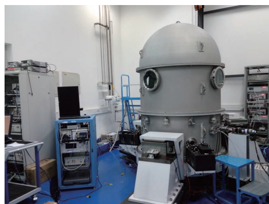
图 12 能量天平实验装置实物
