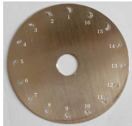
图 10 多注漂移管末端的电子束束斑
