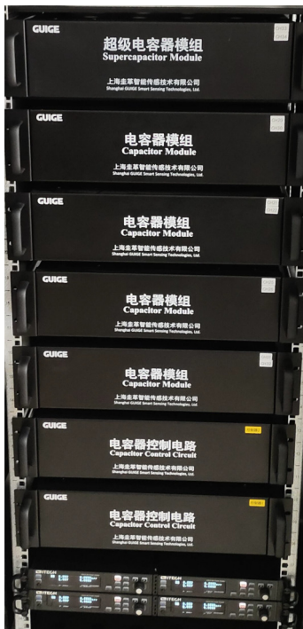
图 6 组装完成的超级电容器控制电路实物图
