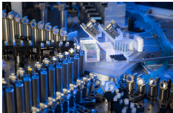
图 2 “九章”系列光量子计算原型机 Fig. 2. “Jiuzhang” series photonics quantum computing prototype.
